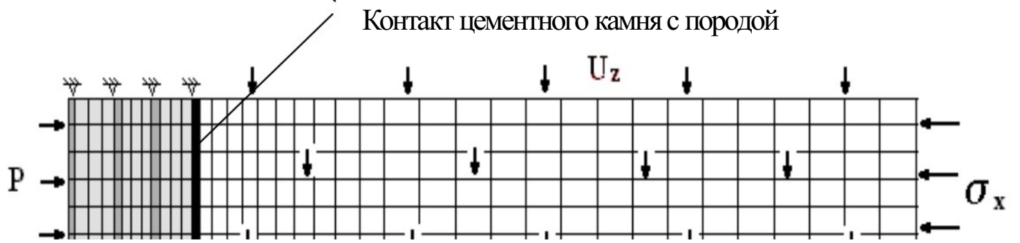
Рис.3. Схема пошагового нагружения при расчете в программном комплексе «Ansys»
